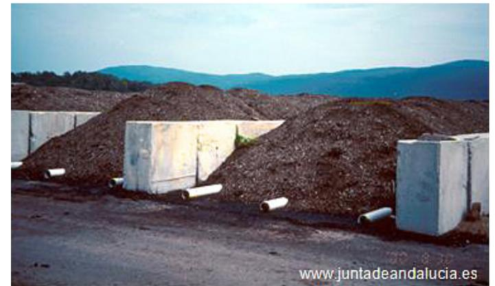
Fotografía 2. Detalle de pilas estáticas con aireación pasiva.
