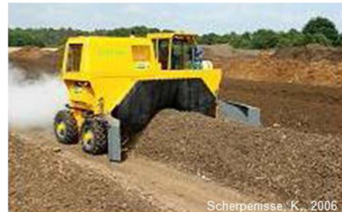
Fotografía 4. Volteo y mezclado de hileras con maquinaria especializada
