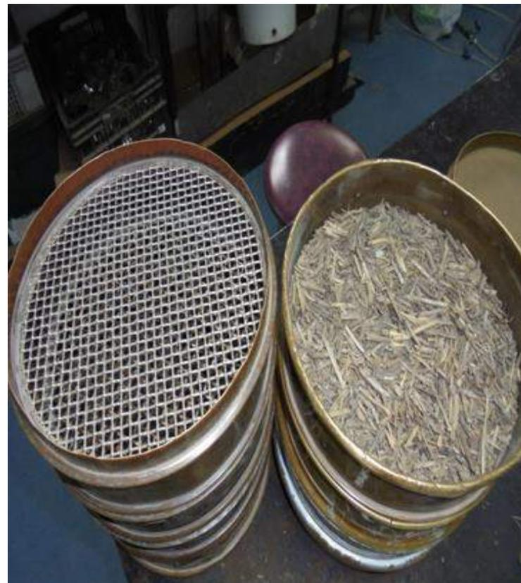
Juego de tamices utilizados para determinar tamaño de partículas de rastrojo de trigo, en función de abertura de tamiz.
