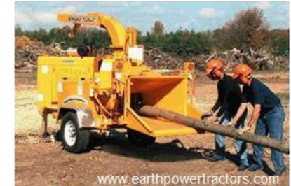
Fotografía 6. Trituradora con una boca de entrada para residuos de 10-30 cm.
