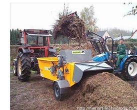
Fotografía 5. Trituradora de residuos agrícolas alimentada en forma permanente por minicargador.
