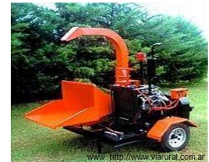
Fotografía 7. Trituradora estacionaria usada en sector agrícola y forestal.
