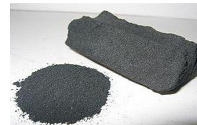
Fotografía 4. Carbón activado sólido y en polvo, fabricado con cáscara de arroz.
